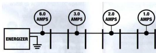
La corriente (Amp) disminuye levemente a medida que se aleja del electrificador
