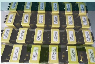
Transformadores del elevador
