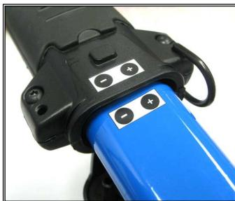
Inserte la batería alineando el + y -. Vuelva a colocar la tapa.
