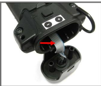
Tire de la tapa del extremo hacia abajo y tener cuidado con el cable interno.
